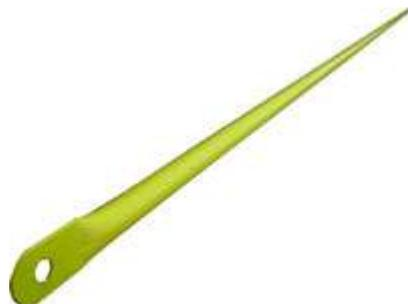
Связь горизонтальная изготовлена из трубы  $\text{O } 25 \times 1,5$  мм. Имеет габариты – длина 3050 мм, масса 3,25 кг, длина 2000 мм, масса 2,12 кг. Служит для связи вертикальных рам и обеспечения необходимой дистанции между ними.
