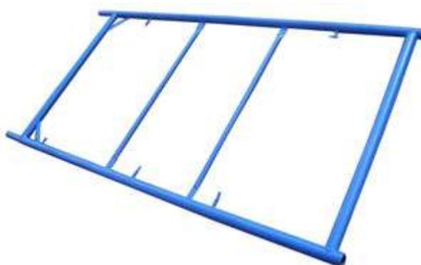
Рама ЛРП-2000-30 изготовлена из трубы, Ø 42x1,5 мм. Имеет габаритные размеры – высота - 2000 мм, ширина - 1000 мм, масса 13 кг. На рамах предусмотрены замки (с фиксатором для крепления диагональных стяжек и связей), а также горизонтальное ограждение согласно ГОСТ 27321-87.
