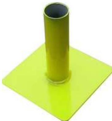
Башмак опорный. Имеет габариты – 120\*120 мм, О 25x1,5 мм, масса 0,7 кг Служит основанием нижнего ряда вертикальных рам лесов, принимает на себя вертикальные нагрузки от лесов и передает их на грунт посредством дополнительных деревянных подкладок.
