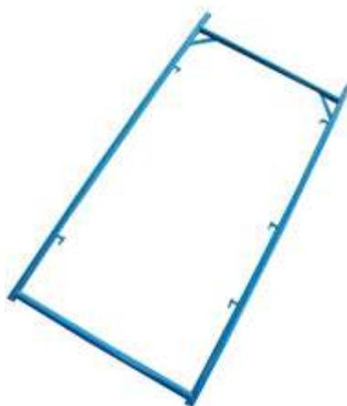
Рама без лестницы ЛРП 200-30 изготовлена из профильной трубы 42\*1,5 мм.. Имеет габаритные размеры – высота - 2000 мм, ширина - 1000 мм, масса 12 кг. На раму приварены пять флажковых фиксатора. Верхняя перемычка усилена косынками из полосы 30\*4 мм. Рама без лестницы является основным элементом и служит для наращивания лесов до необходимой высоты.
