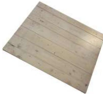
Настил деревянный. Имеет габариты – ширина 1000 мм, длина 980 мм, масса 12 кг, изготавливается из досок 2-го сорта ГОСТ 8486-86, толщиной 25 мм. Служит для горизонтального перемещения рабочих и принятия нагрузок, возникающих от бригад рабочих и строительного-отделочных материалов.
