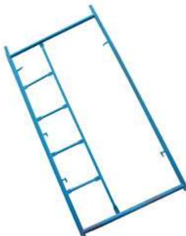
Рама с лестницей ЛРП 2000-30 изготовлена из трубы, 42\*1,5 мм. Имеет габаритные размеры – высота - 2000 мм, ширина - 1000 мм, масса 15 кг. Является основным элементом и служит для наращивания лесов до необходимой высоты. На рамах предусмотрены замки (с фиксатором для крепления диагональных стяжек и связей). Рама с лестницей является также межэтажным переходом для рабочих для их вертикального перемещения.
