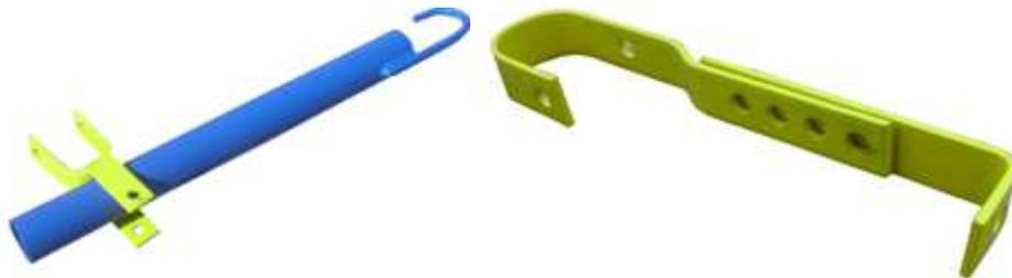
Кронштейн - служит для крепления строительных лесов. Изготавливается из полосы 30\*4 мм.. Крепление конструкции лесов к стене происходит с помощью кронштейнов и анкера, которые крепятся непосредственно к каждой раме по всей высоте лесов. Анкерные болты в комплекте с кронштейнами не поставляются.
